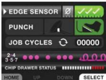
Rys. 14. Ekran główny z włączonym czujnikiem brzegu (EDGE SENSOR) i włączoną obsługą za pomocą pedału (FOOT PEDAL).
